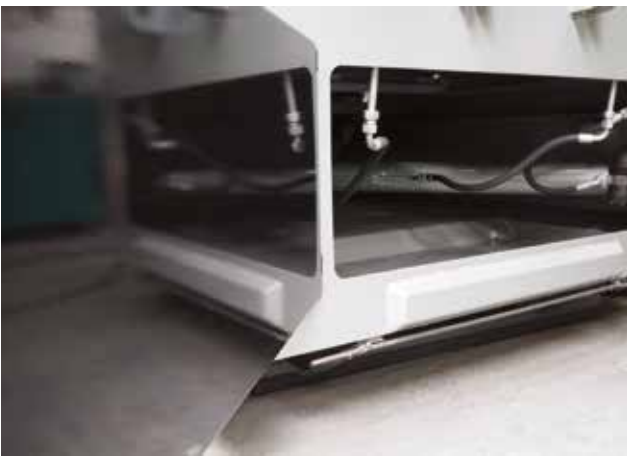
Selbstreinigungswanne im Presskopf
