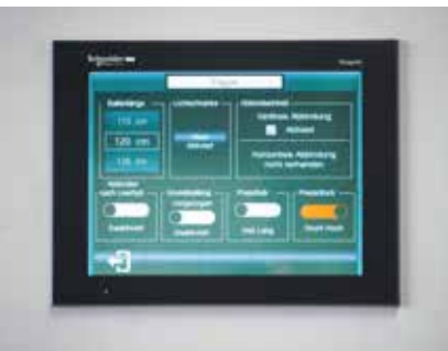
Touchscreen-Display zum Einstellen für individuelle Materialparameter
