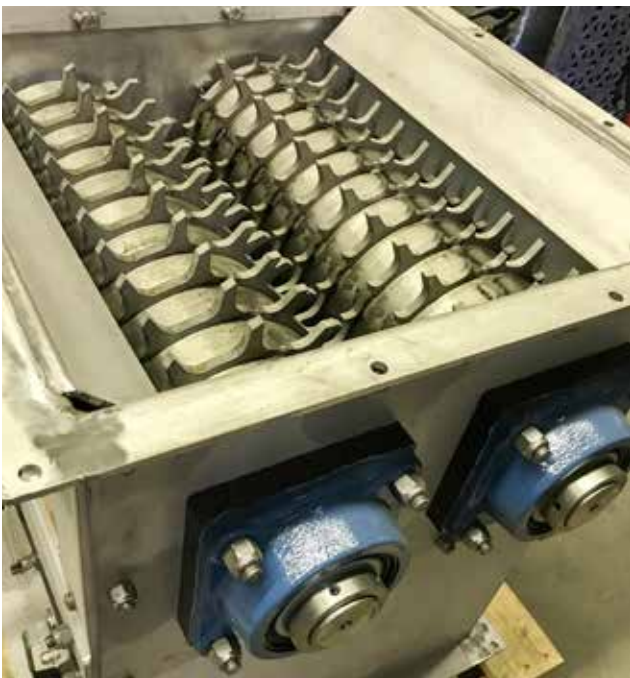
Robuste 10 mm Edelstahlzähne
