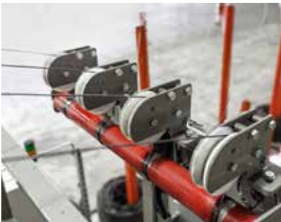
Drahttriss- und Drahtendeüberwachung zur Kontrolle der Bindedrähte
